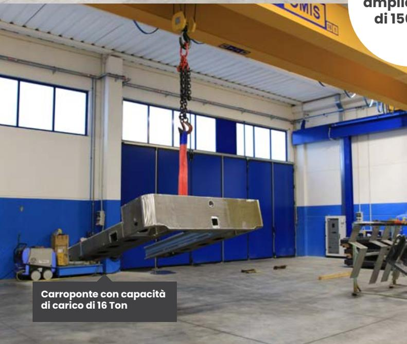
Carroponte con capacità di carico di 16 Ton
